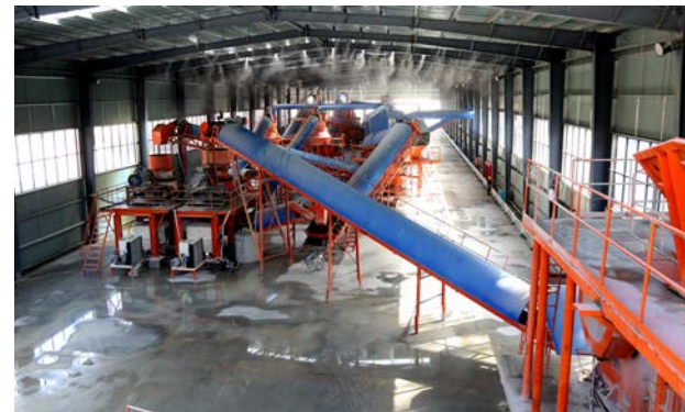
物资公司砂石料加工厂，装备国内先进砂石料生产线的全封闭式降尘降噪车间
